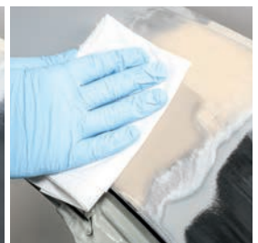
Toode BONDERITE M-NT Aurustumisaeg 5 min, 1455 W on mõeldud ainult enne kui võib alustada halja metalli töötlemiseks. värvimist Hoidke märg 2 min.
