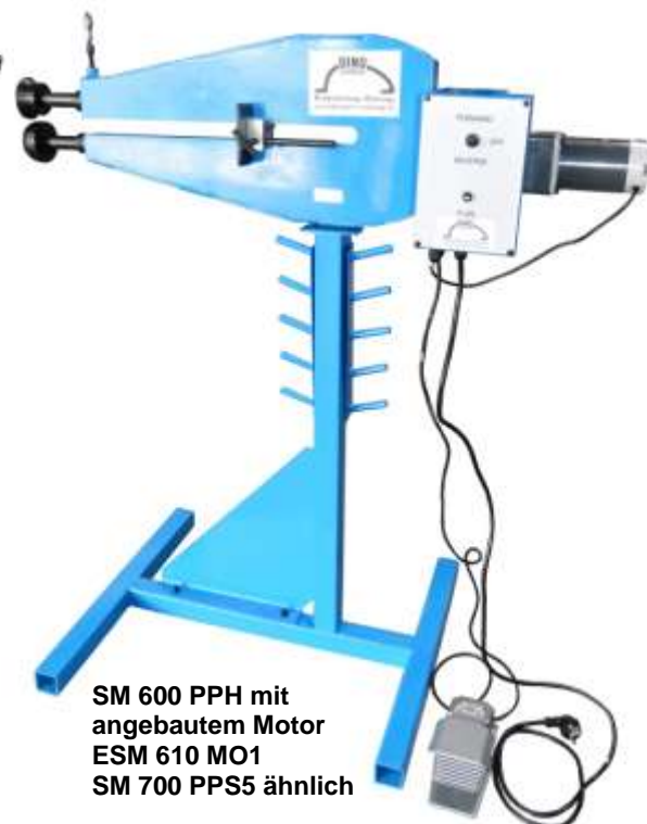
Rundaufstell- walzenpaar in Lieferumfang der SM 600 PPH enthalten
