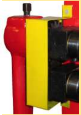
Sicherheitsabdeckung der Antriebsräder SM 100 SA+SM 180 SPG1
