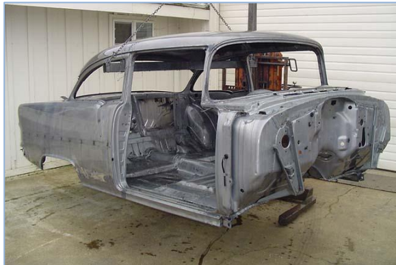
Pilt 19 – Peale töötlust jääb alles vaid haljas metall.
