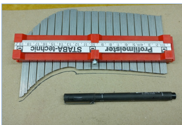
Pilt 147: Šablooniga abil saadud kontuur kantakse paberile.
