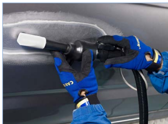
Pilt 113: Kuumkahandamine induksioonkuumuti abil.
