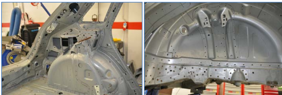
Pilt 7, 8: Punktkeevitusega liidetud keredetailid.
