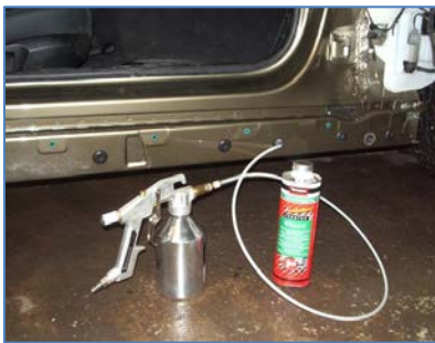
Pilt 59: Õõnsuste sisevahatamine tagab korrosioonikindluse.
