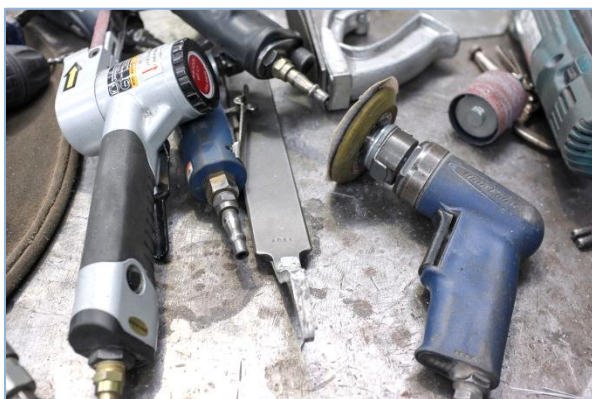
Pilt 142, 143: Lisaks käsitööriistadele on viimistlemisel abi erineva suurusega lihvmasinatelt. Valik plekksepa töölaualt.
