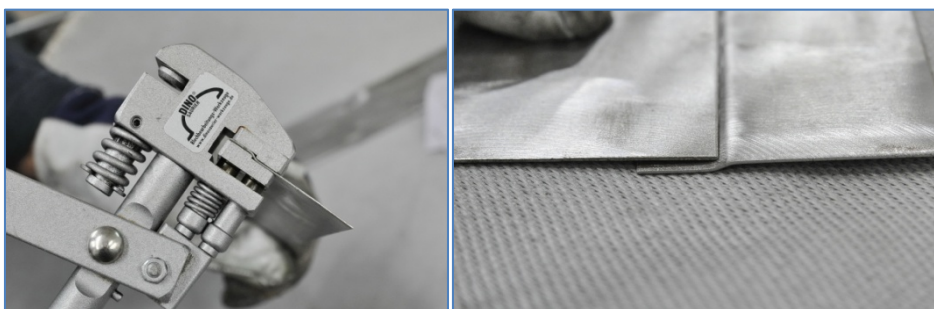
Pilt 11, 12: Astmetangid ja astmevaba ülekattega plekiserva ühendus.
