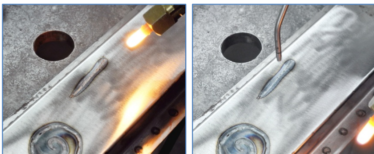
Pilt 68, 69: Kuumutamine triibuna ja jahutus.
