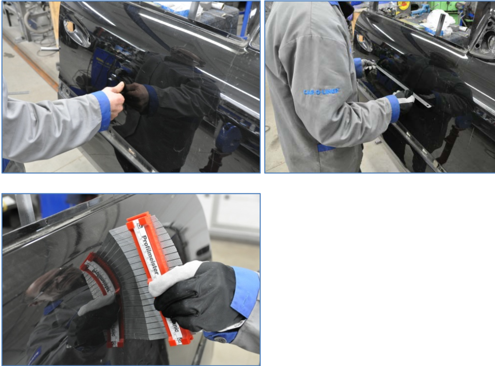
Pilt 3-7: Keredetailide vigastuste hindamise meetodid.
