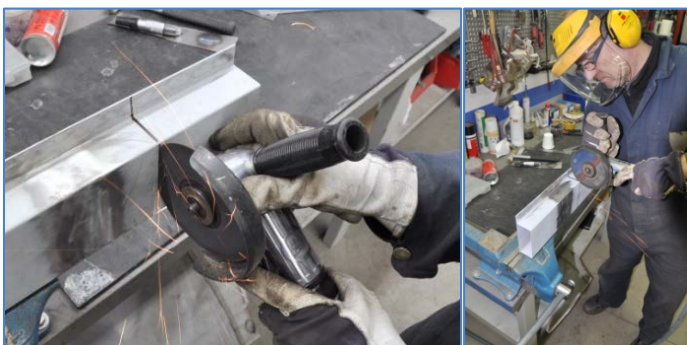
Pilt 23, 24: Korpuse esiosast kinnihoidmine võimaldab toetada nimetissõrm pinnale ja juhtida täpselt lõikeketta liikumist. Vältida tuleks sädemevihu lendamist otse riietele – kiirelt lendavad sädemed põletavad riidesse augud.
