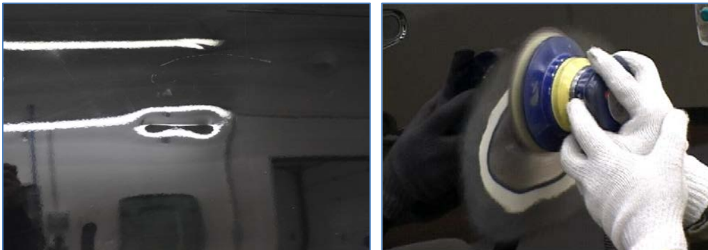
Pilt 30, 31: Värviläike pealt on lihtsam jälgida õgvendustööde tulemust. Peale õgvendustööde lõppu mõranenud värvi eemaldamine ja üleminekute sujuv maha lihvimine.
