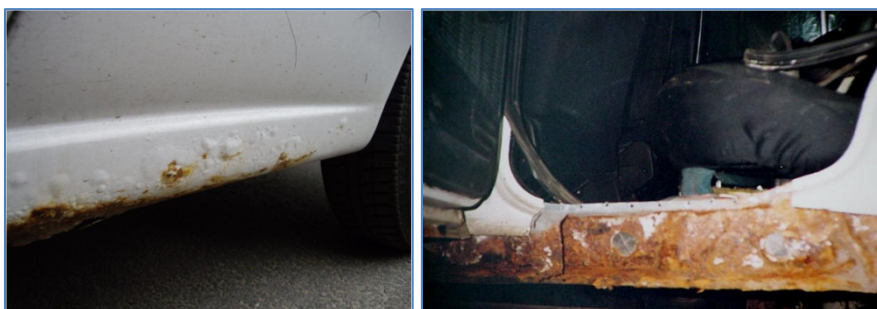
Pildid 46, 47: Kahjustustega lävekarb väljast- ja seestpoolt.
