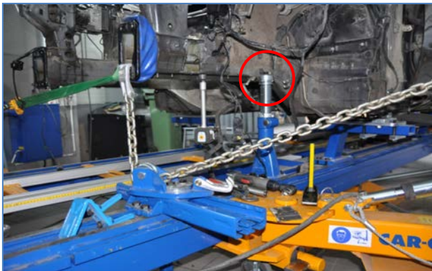
Pilt 16: Vigastamata kohast toetatud esipikitala allatõmbe teostamiseks.
