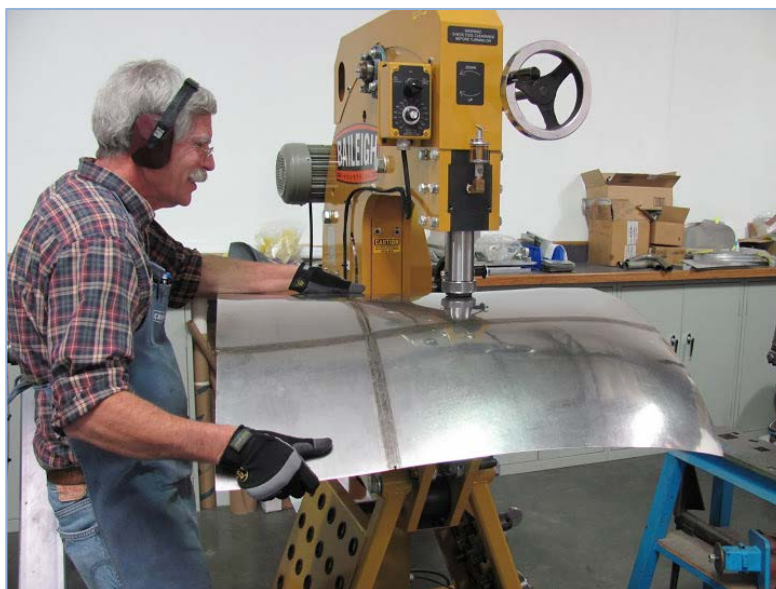
Pilt 136, 137: USA firma Baileigh on välja töötanud kombineeritud jõuvasara, milles on ühendatud mitme seadme omadused.
