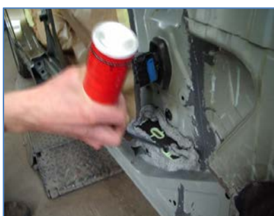
Pilt 54: Piilarivahu kasutamine mürasummutusplaadi paigaldusel.
