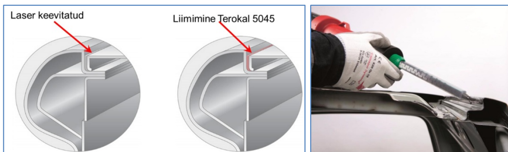
Pilt 38, 39: Tehases laserkeevitatud katusepaneel paigaldatakse remondi käigus liimiga.
