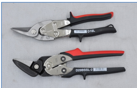
Pilt 10: Üleval väänatud otstega ja all sirgete otstega plekikäärid.
