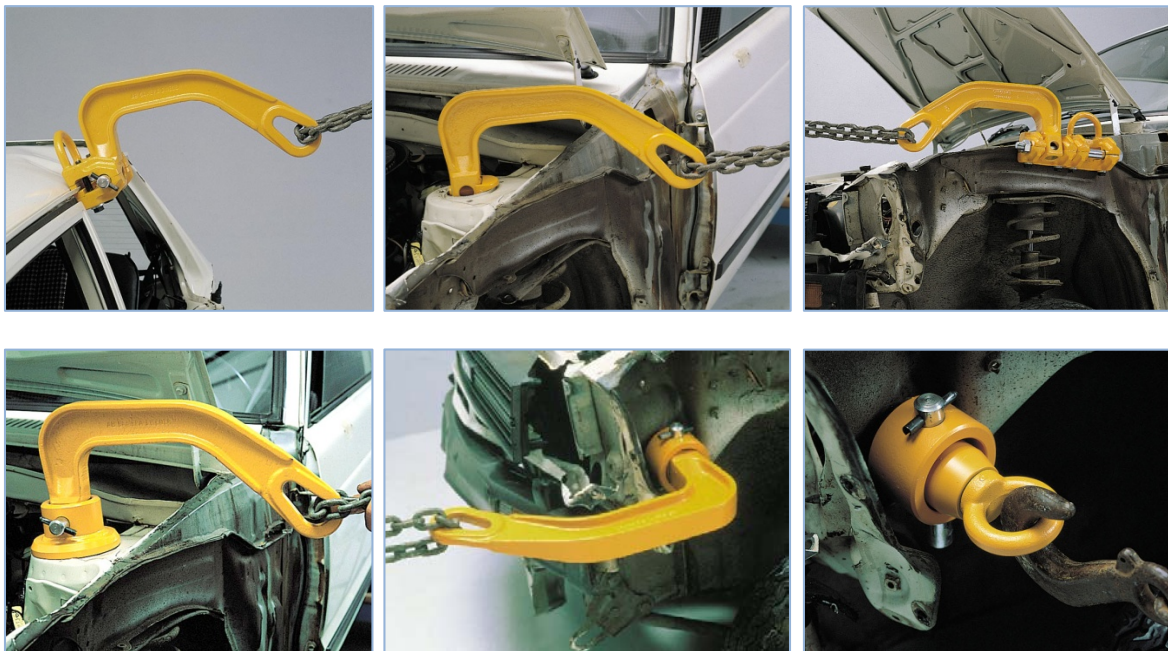
Pilt 109: universaalse venituskonksu ja selle lisavarustuse kasutusvõimalused.
