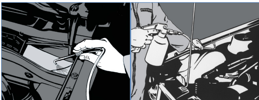
Pilt 58: Mootoriruumi töötlemine L-kujulise sondiga.
