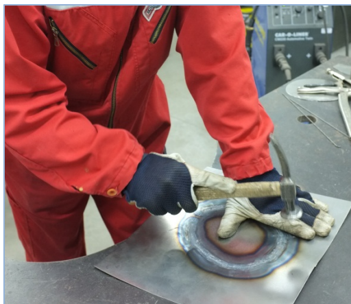
7. Esimene keevituse õgvendus vasaraga terasplaadil
