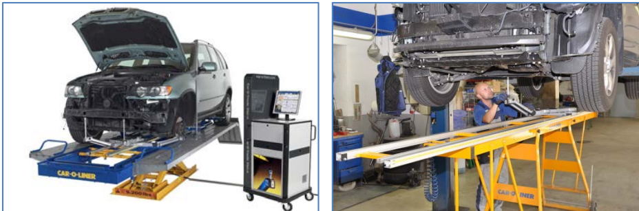
Pilt 144, 145: Car-O-Liner Vision X3 mõõtesüsteemi kasutamine kerevenituspingil ja eraldiseisvana.
