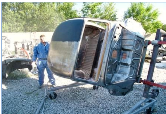
Pilt 14 – Auto kere puhastamine soodapriitsimise abil.
