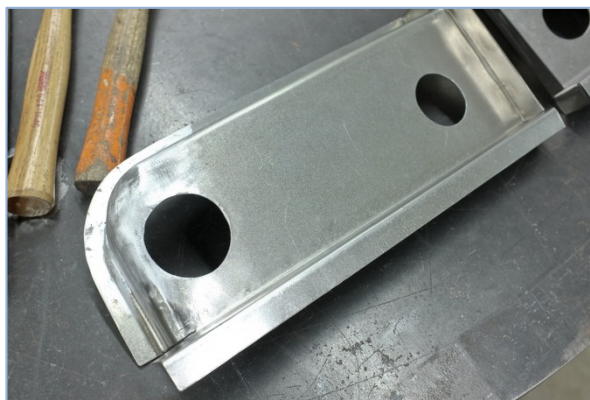
Pilt 95, 96: Selliste detailide ja detailikoosluste valmistamisel on kasutatud peamiselt kantpinkki ja selle eri võimalusi.
