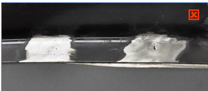
Pilt 67: Ebakorrektnel keevisõmblus ja viimistlus: poorselt keevitatud korkõmblus ja lohku lihvitud tasapind.
