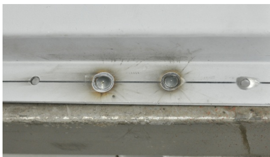
Pilt 14: Kvaliteetne korkkeevitus keskel, vasakul perforeeritud ava, paremal korkkeevituseks ettevalmistatud ava.
