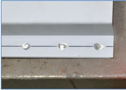
Pilt 37: Kvaliteetselt ettevalmistatud pinnad korkkeevituse teostamiseks.
