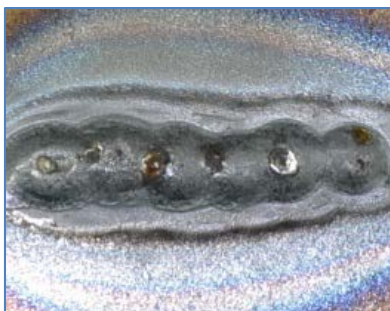
Pilt 51: Paneeli tagaküljel on punktid omavahel korralikult kokku sulanud.
