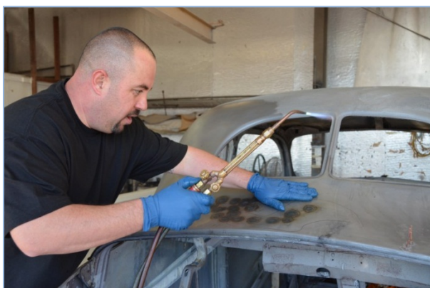
Pilt 112: Kuumkahandamine gaasikeevitusseadme abil.
