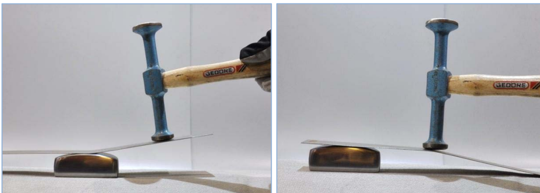
Pilt 24, 25: Elastse deformatsiooni õgvendamiseks toesta alasiga lähim mittevigastatud pind ning kergete koputustega õgvendada tasapind esialgsesse kujusse.
