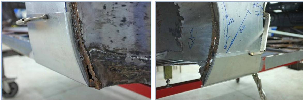
Pilt 153, 154: Tagatiiva asendusdetaili valmistamisel painutati plekk kõigepealt kaarjaks, seejärel kanditi serv sikemasinaga
