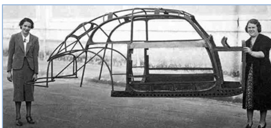
Pilt 14 – Superleggera alusraam oli ülikerge (Alfa-Romeo). Pilt 15 – BMW 328 alusraami suutis kanda 1 inimene.
