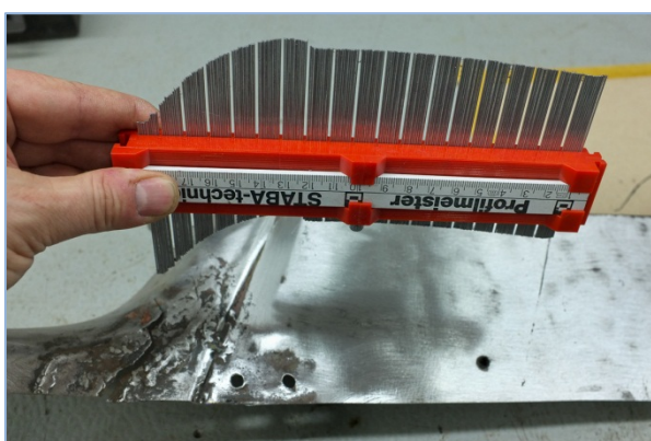
Pilt 146: Detaili kuju saab kopeerida kontuuršablooniga.
