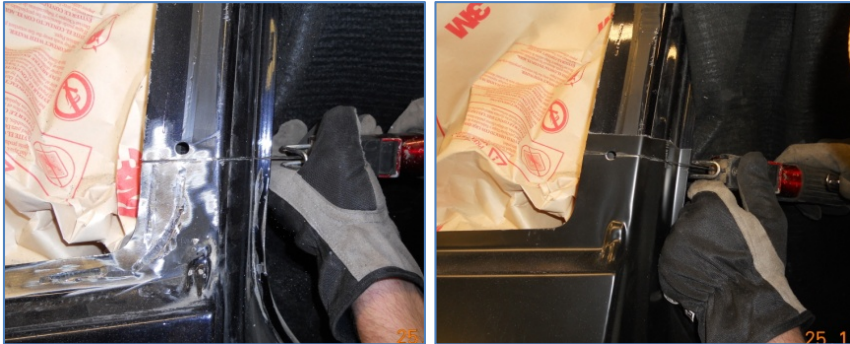
Pilt 19, 20: Vana detaili varuga maha lõikamine ja täpse lõike tegemine koos kohale sobitatud uue detailiga.
