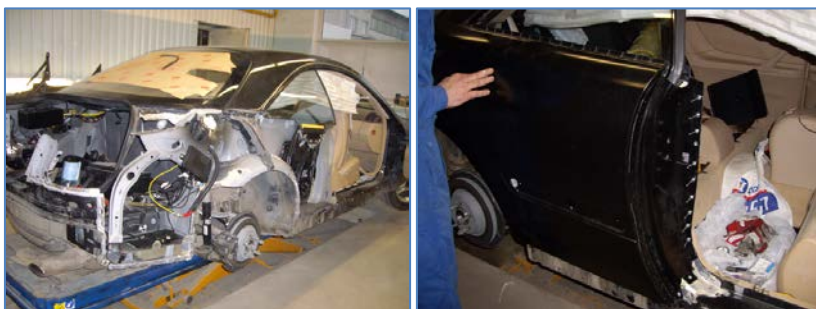
Pilt 36, 37: DC 500 Coupe küljepaneeli paigaldamisel kasutatakse lisaks neetimisele ka liimühendust.
