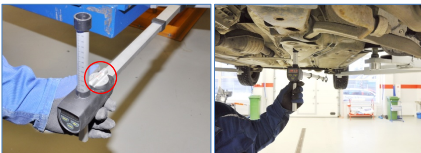
Pilt 133, 134: Vesiloodiga varustatud mõõtejoonlauaga projitseeritud mõõdu võtmine.
