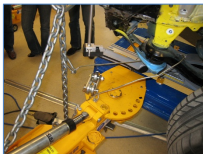
Pilt 125: Turvatrossi paigaldamine venitusrakise ja keti kinnitamiseks.
