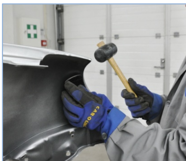
Pilt 15: Detailile esmane ligilähedase kuju andmine kõva kummivasaraga.
