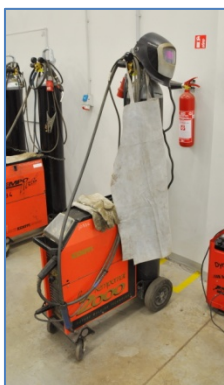
Pilt 105: Keevitustööde „põhivarustus“ – keevitus, keevituskindad, -põll, -mask ja tulekustuti.
