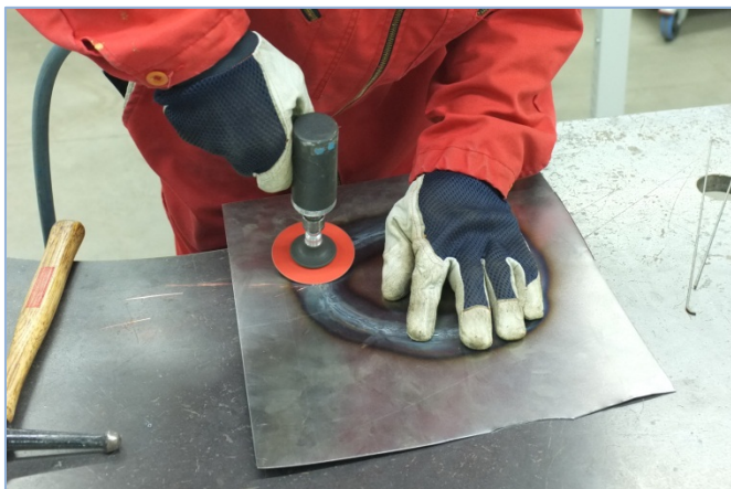
6. Kerge töötus P50 Roloc-kettaga, et eemaldada kõrgemad alad
