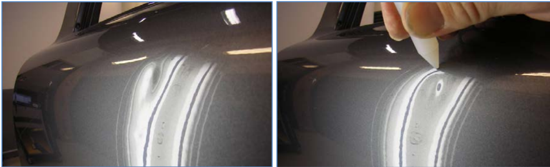
Pilt 38, 39: Väljapoole surutud mõlgi servasid tasandatakse kaprontorni abil.
