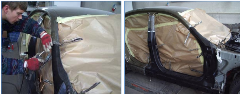
Pilt 57, 58: Fiksaatoritangide kasutamine paneeli esmaseks fikseerimiseks.
