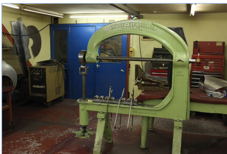
Pilt 129, 130: Klassikaline English Wheel, nii nagu neid Inglismaal üle 100 aasta on kasutatud – valuraami ja keskvõlliga.
