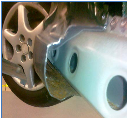
Pilt 5: Seestpoolt väljapoole toimiv korrosioon.
