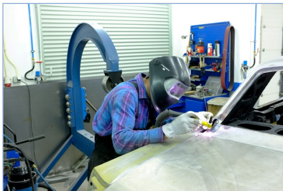
Pilt 160: Järgneb pidev keevitus TIG-keevitusseadmega.
