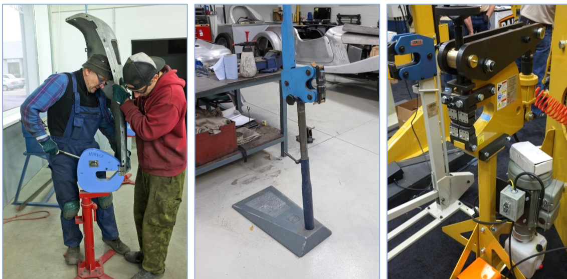
Pilt 103-105: Pleki kahandamine mehaanilise kahandusseadmega ( i. shrinker ) ja erinevad kahandusseadmed.
