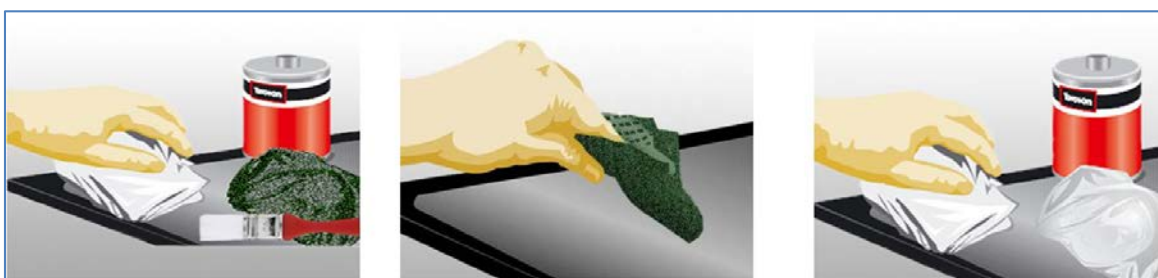
Pilt 26: Klaasi serva puhastamine eelpuhastusvahendiga.
