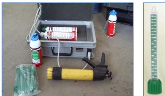
Pilt 49: Padrunite eelsoojenduskohver, 2K kereliim ja segamisotsikud, hermeetikupüstol ja piilari mürasummutusvaht. Segamisotsik segab erinevad liimikomponendid ühtlaseks massiks.
