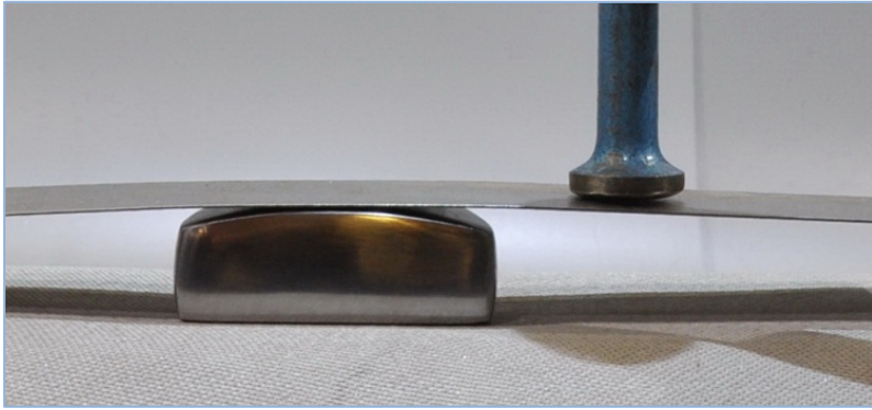
Pilt 21: Alasist mööda löömise tehnika.
