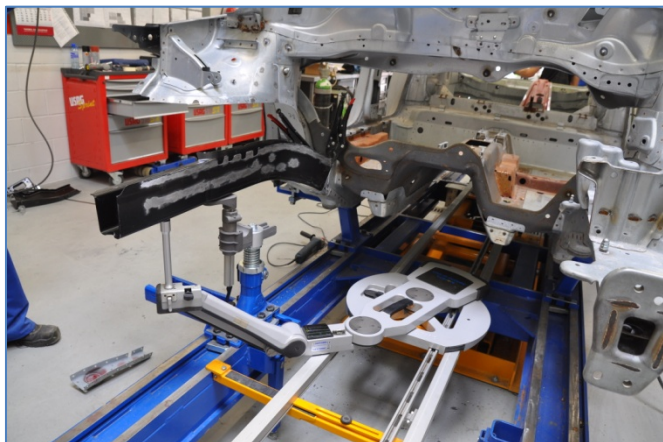
Pilt 29: Esipikitala paigaldamine autokere suhtes täpsesse kohta konduktorite ja mõõtesüsteemi abil.
