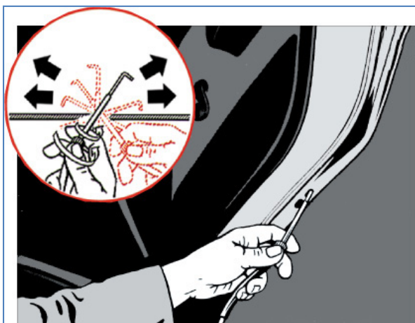
Pilt 51: Ukse sisenurga töötlemine L-kujulise sondiga.
