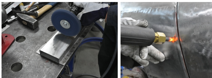
Pilt 64, 65: Pinna puhastamine enne söepulga kasutamist. Kohtkuumus söepulgaga.
