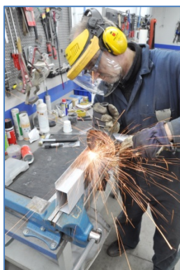
Pilt 106: Lõikamis- ja käimistööde juures tuleb kanda kaitsevisiiri või –prille. Kõrvaklapid aitavad säästa kõrvu müra eest nii käimisel kui ka pleki õgvendamisel juures.
