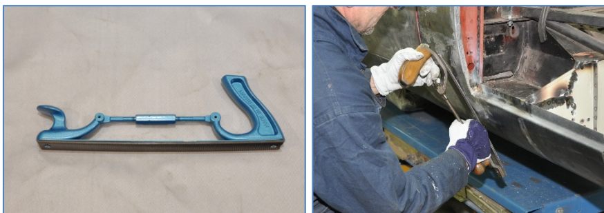
Pilt 13, 14: Muudetava kumerusega kerehöövel ja selle kasutamine tina raspeldamiseks.
