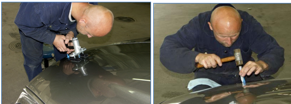
Pilt 44, 45: Mõlgi eemaldamine alumiiniumkapotilt kasutades liimtõmbajat ja kapronvasarat.
