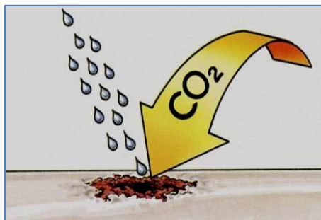
Pilt 1: Elektrokeemilise korrosiooni teke.
