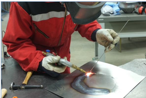
5. Peale punkitud servade sirgestamist ühendatakse detailid gaasikeevituse abil, selline näeb välja korrektne keevitusjalg.
