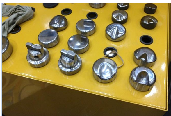
Pilt 138, 139: Ka Baileigh kasutab kahandamiseks nn. komakujulisi otsikuid. Otsikute valik on väga lai.
