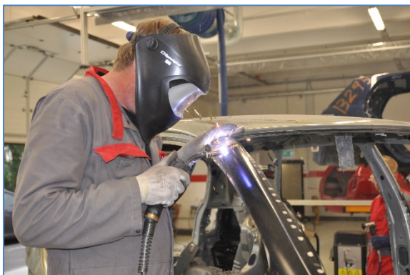
Pilt 144 – Asendusdetaili keevitamine MIG-keevitusega
