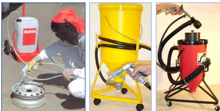
Pildid 11, 12, 13 – Punktliivapritsi on tõhus abiline kiireks ja täielikuks rooste eemaldamiseks.
