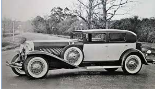
Pilt 10 ja 11 – Näited ilusaimatest Weymann-konstruksiooniga keredega autodest 1930-ndatel.
