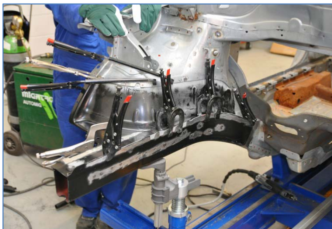
Pilt 30: Esimese rattakoopa asendusdetailide paigaldamine ja fikseerimine esipikitala külge.
