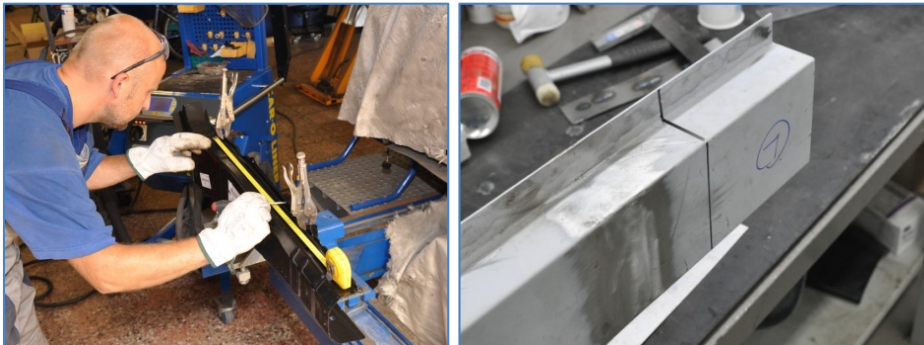
Pilt 21, 22: Lõikekoht on vaja täpselt välja mõõta ning märkida detailile vastav lõikejoon.
