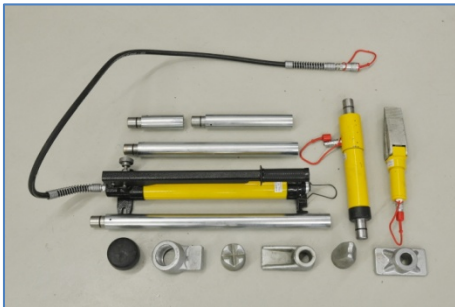
Pilt 117: Hüdrotungraua komplekt surumiseks ja toestamiseks.
