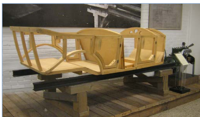
Pilt 4 – Esimese Volvo sõiduauto (Jacob) kerekonstruktsioon.
