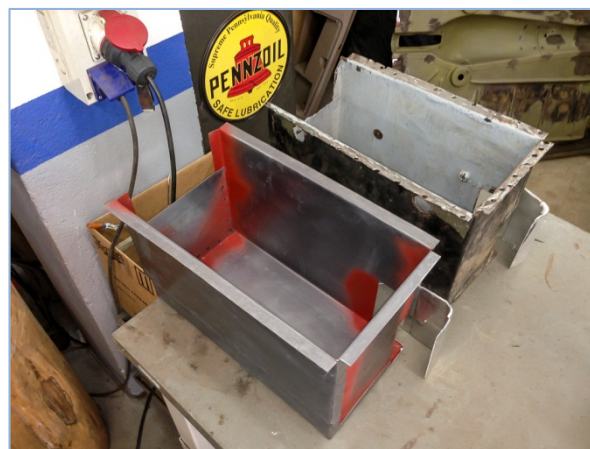
Pilt 97, 98: Selle akukasti koopia valmistamisel kasutati ainult kantmasinat, alumiiniumvasarat/alasi ning punktkeevitust.
