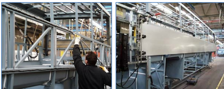
Pilt 40, 41: Bussi kerepaneeli liimimine tugev-elastse MS Polümeer liimiga.
