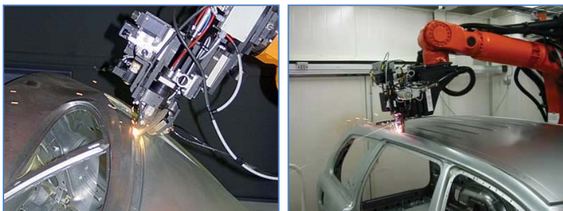
Pilt 9, 10: Laser- ehk rullkeevituse abil keevitatakse katusepaneel.
