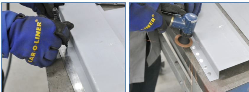
Pilt 84, 85: Punktide märkimine ja puhastamine paneeli välisküljel.
