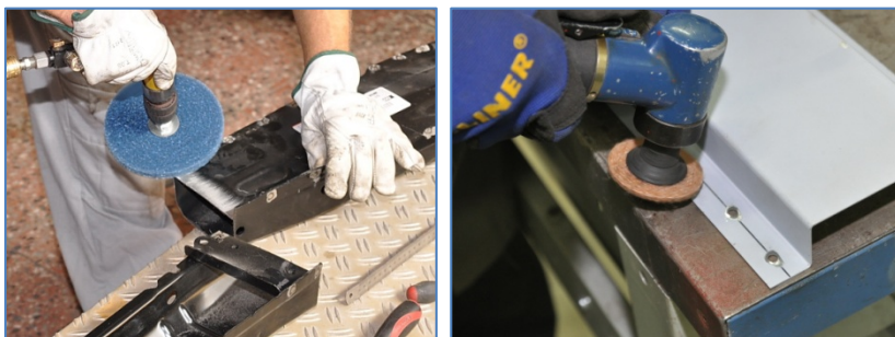
Pilt 27, 28: Pinna puhastamine värvist kärgeketta ja roloc-ketta abil.
