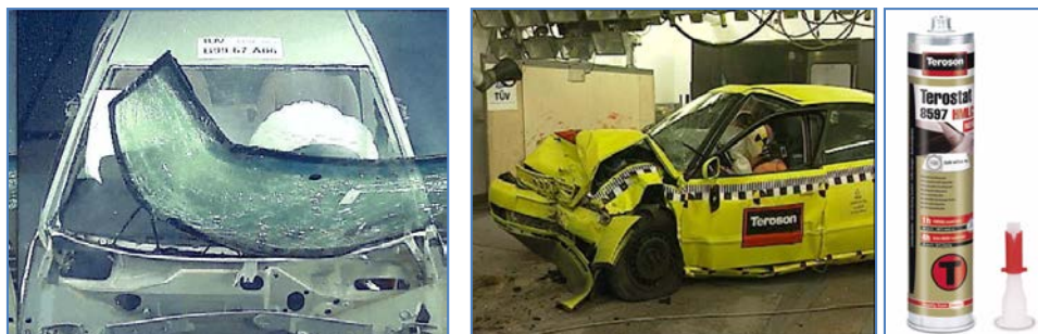
Pilt 14, 15: Vasakul avarii eraldunud esiklaas, mis ei paku turvalisust autos viibijatele. Paremal Teroson HM liimiga liimitud esiklaasiga auto kokkupõrke test.
