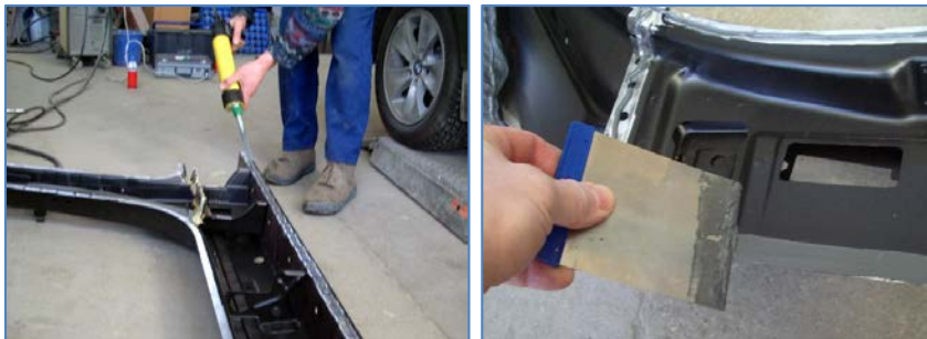
Pilt 51, 52: Liimiriba pealekandmine ühenduskohale. Pahtlilabidaga liimi tasandamine ja laalimäärimine kogu ühenduspinnale uuel paneelil...
