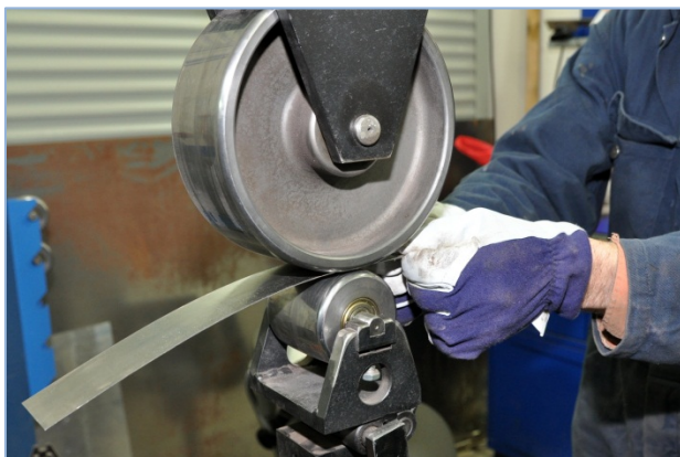
Pilt 155: Plekki töödeldakse edasi-tagasi liigutuste abil.
