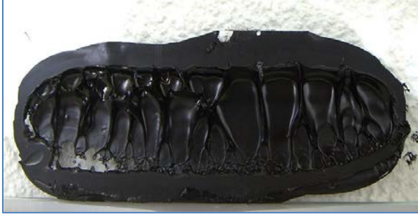
Pilt 42: Ühekomponentse liimiga teostatud liimühendus peale 24 tunni möödumist.
