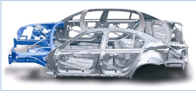
Pilt 56: BMW 5-seeria autodel on esiosa parema kaalujaotuse huvides valmistatud alumiiniumist.
