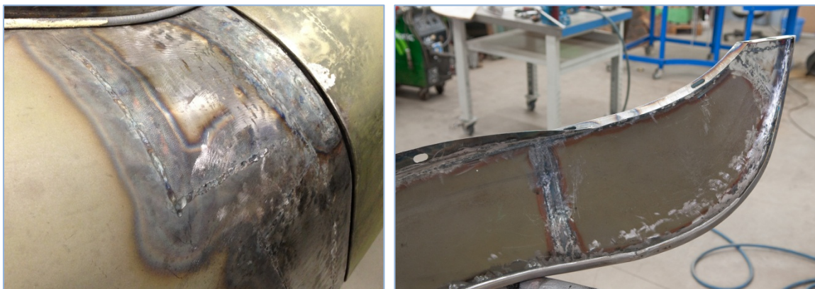
Pilt 116, 117: Asendusdetailide valmistamisel ja paigaldamisel kasutatakse peamiselt serv-servaga põkkkeevitamist.
