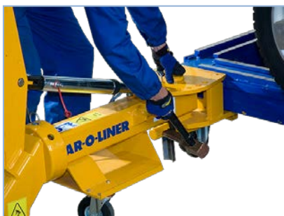
Pilt 123: Kiilu paigaldamine pronksvasaraga.
