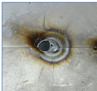
Pilt 57: Metalli läbisulamine, augud – keevitusvool liialt suur, keevituskäpp liialt lähedal või tema liigutamise kiirus liiga väike.
