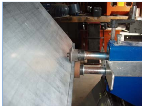
Pilt 124, 125: Sikemasin on vajalik seade keerukamate asendusdetailide valmistamiseks ja seega hea investering
