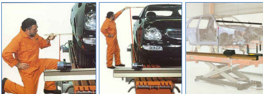
Pilt 139-141: Punkti kauguse mõõtmine laserkiirega tekitatud koordinaatteljest ja automaatne punktidele laserkiirega mõõtmine punktidele kinnitatud peegeldite abil.
