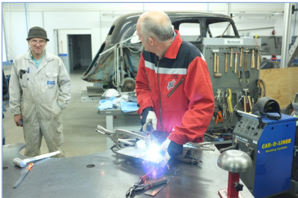
3. Asendusosa kinnitatakse MIG-keevitusega punktides
