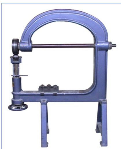
Pilt 129, 130: Klassikaline English Wheel, nii nagu neid Inglismaal üle 100 aasta on kasutatud – valuraami ja keskvõlliga.
