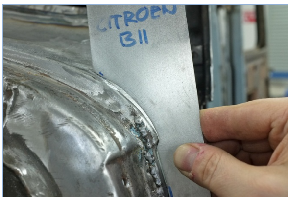
Pilt 148: Saadud metallkontuuri kasutatakse detaili valmistamisel.
