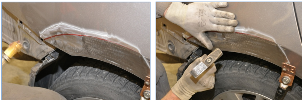
Pildid 55-58: Tõmbevasaraga tuleb deformatsiooni õgvendamist alustada alati selle servast ja liikuda deformatsiooni keskmise suunas.
