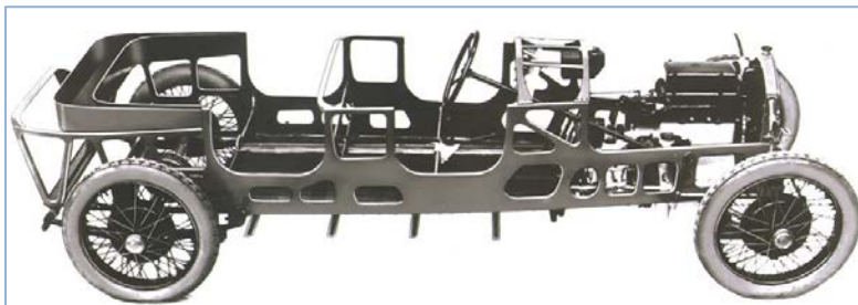
Pilt 22 – Lancia Lambda – esimene kandevkerega auto konstruktsioon.
