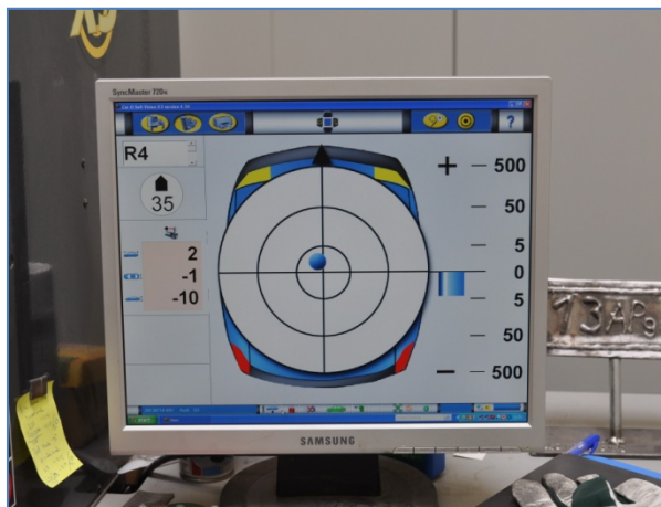
Pilt 27: Mõõtesüsteemi „märklaud“, mis näitab mõõtepunkti liikumist reaajas ja kolmes suunas samaaegselt. Antud näites on punkt vaja venitada 10 mm ülespoole, pikkus- ja külgsuuna mõõt on tolerantsi (+/- 3 mm) piires.
