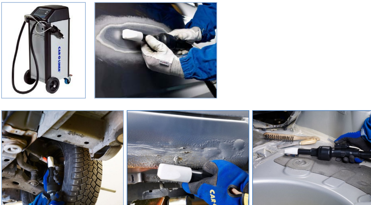
Pilt 58-62: Induksioonkuumuti ja selle kasutuskohad.
