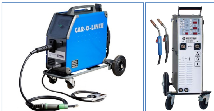
Pilt 43, 44: Sünergilise ja sünergilis-adaptiivse juhtimisega MIG/MAG keevitusaparaadid.
