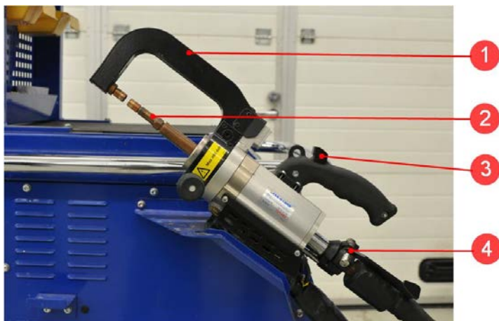
Pilt 90: Keevituskäpa osad: 1.vahetatav keevituskaar, 2.liikuv elektrood, 3.käepide koos päästikuga, 4. liikuva elektroodi fikseerimisklamber.
