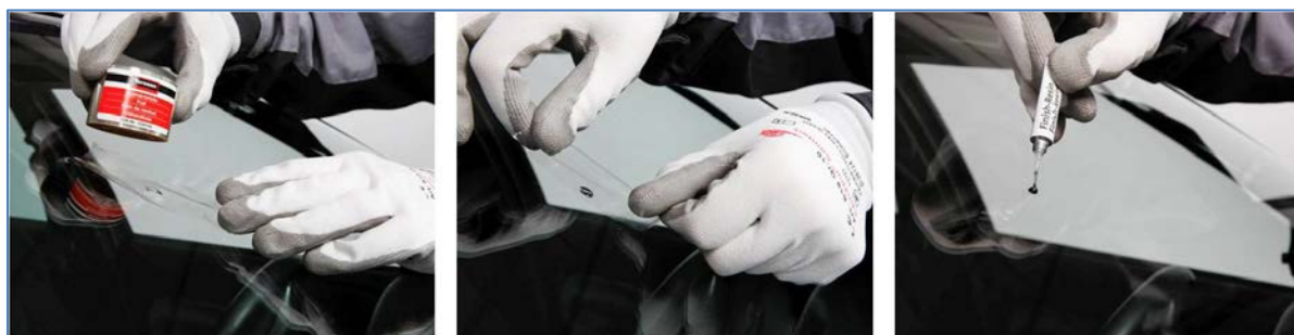
Pilt 46-48: Fooliumi ja viimistlusvaigu paigaldamine klaasitükke kraatrile.
