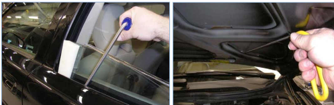
Pilt 35, 36: Õgvendusvarrastega ukse seest ja kapoti raami vahelt õgvendamine.
