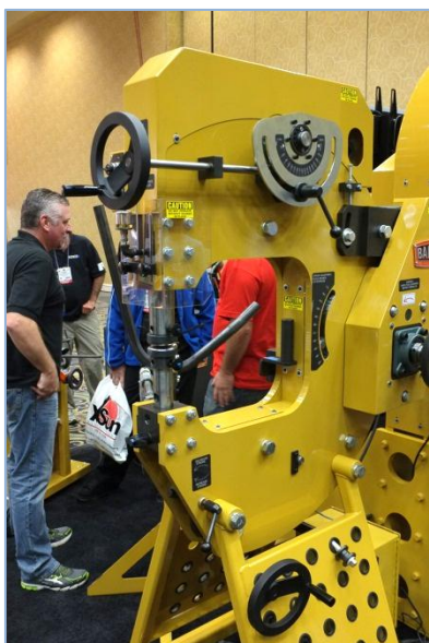
Pilt 136, 137: USA firma Baileigh on välja töötanud kombineeritud jõuvasara, milles on ühendatud mitme seadme omadused.
