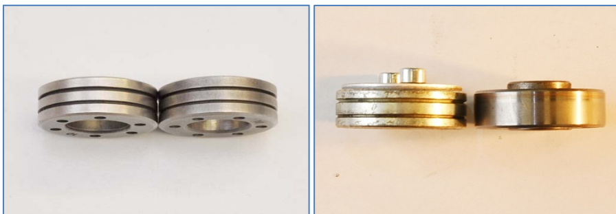
Pilt 40, 41: Keevitustraadi etteande rullid, vasakul ümar soon mõlemal rullikul (Cu ja Al traadile), paremal koonilise soonega vedav rull ja sile surverull (terastraadile).
