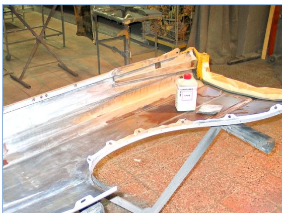
Pildid 16 ja 17 – DuPont Metal Conditioner on fosforhappel põhinev spetsiaalne metallpindade puhasti ja passiveerija.
