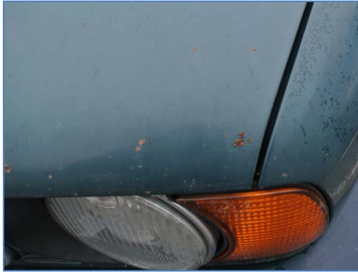
Pilt 4: Kivilöögist tekkinud roostekahjustus.
