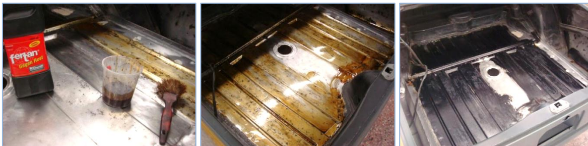
Pildid 22, 23, 24 – FERTAN® võimaldab rooste osaliselt eemaldada ja allesjäänud rooste muundada inertseks aineks
