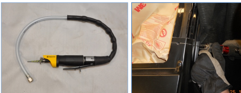
Pilt 25, 26: Tikksaag ja detailide tasalõik.
