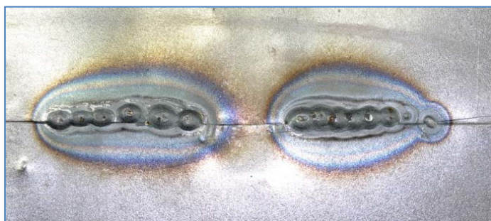
Pilt 59: Samad õmblused vastaspoolelt, vasakpoolsel õmblusel on vahed sees ja pole ühtlaselt läbi keevitatud. Parempoolne on hästi läbi keevitatud.
