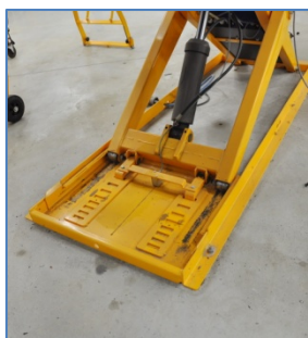
Pilt 122: Kerevenituspingi alla vajumise mehaaniline tõkis.
