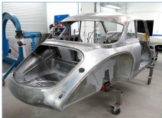
Pilt 15 – Soodapriitsiga puhastatud, haljas teraskere.
