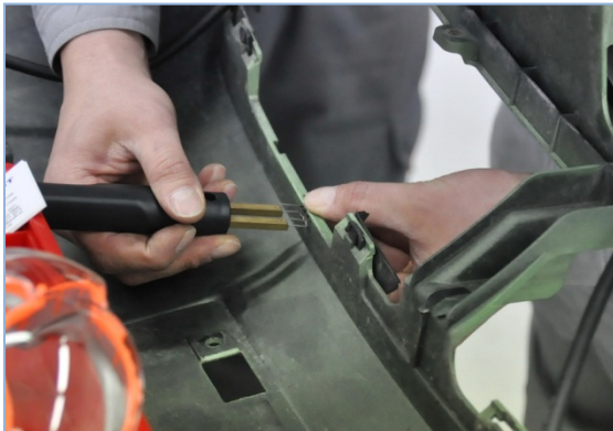
Pilt 30 – Plasti pindade fikseerimine klambrikolviga
