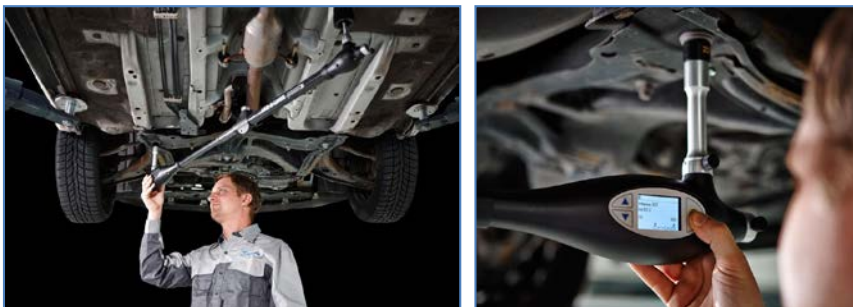
Pilt 148, 149: Car-O-Liner PointX mõõtesüsteemi kasutamine koos ühekäe mõõtmist võimaldava magnetadapteriga.
