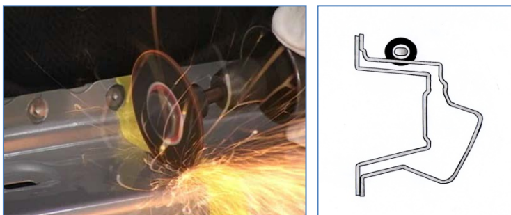
Pilt 25, 26: Turbiini ja mini-lõikekettaga pealmise kihi maha lõikamine.
