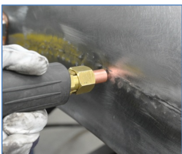
Pilt 73: Vaskelektroodiga väikse väljaulatuva kühmu tasandamine.
