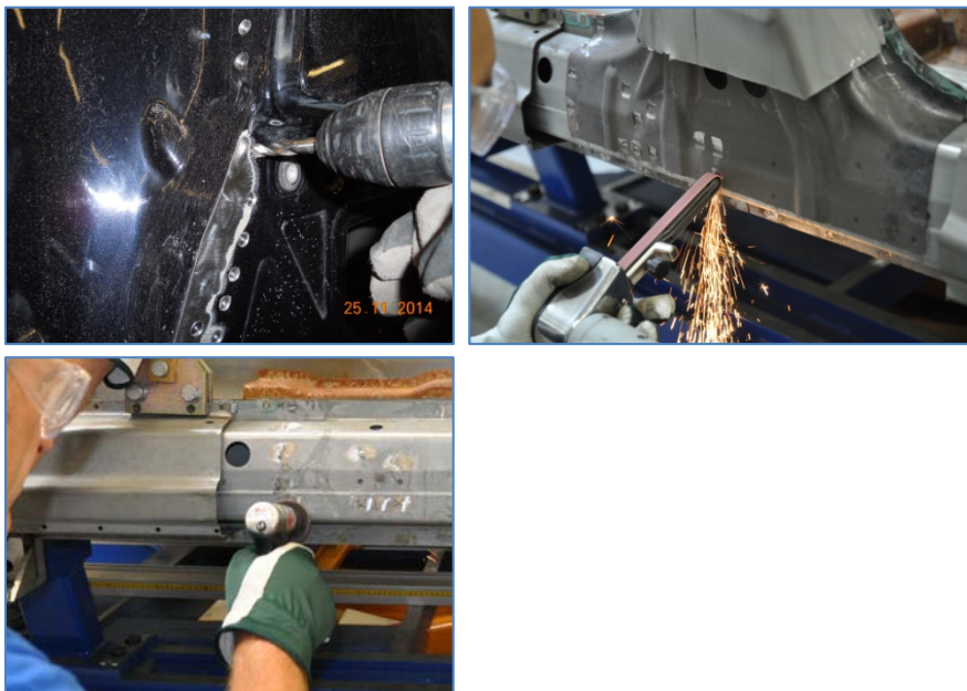
Pilt 80-83: Punktide väljapuurimine. Punktide väljalihvimine lintlihvijaga. Punktkeevituse jäänuste tasandamine mininurklihvijaga.
