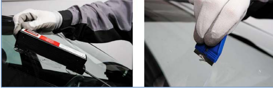
Pilt 49: UV- lambiga vaigu kuivatamine.
