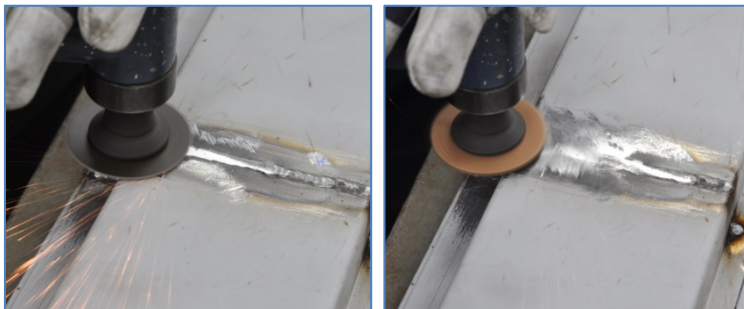
Pilt 62, 63: Keevisvalli tasandamine mini-nurklihvijaga fiiber (vasakul) ja viimistlemine Scotch-Brite kettaga.
