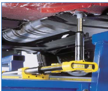
Pilt 150: Autokere nullimine mehaanilise mõõteseadme suhtes.
