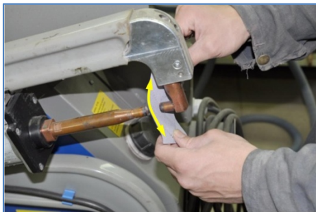
Pilt 101: Elektroodi otsa puhastamine P120 lihvpaperiga.
