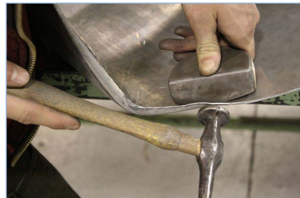
Pilt 90: Plekiserva painutamine vasara ja alasi abil
