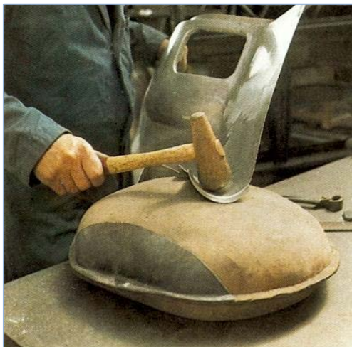
Pilt 99: Pleki venitamine puitvasaraga liivakotil
