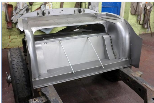
Pilt 95, 96: Selliste detailide ja detailikoosluste valmistamisel on kasutatud peamiselt kantpinkki ja selle eri võimalusi.
