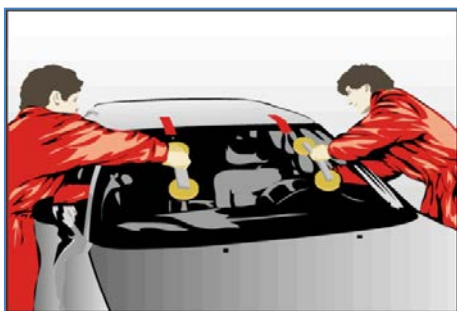
Pilt 33: Klaasi paigaldamiseks on tarvis kahte inimest.
