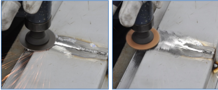
Pilt 21, 22: Keevisvalli tasandamine mini-nurklihvijaga fiiber (vasakul) ja viimistlemine Scotch-Brite kettaga.
