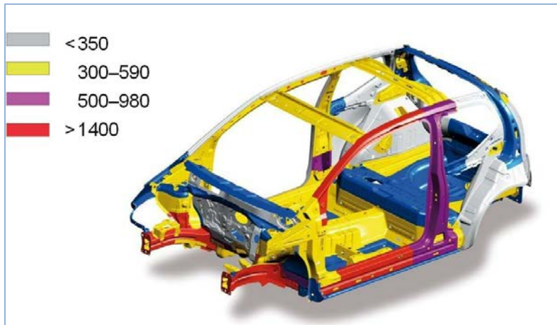
Pilt 58: VW Up kereehituses kasutatavad materjalid.
