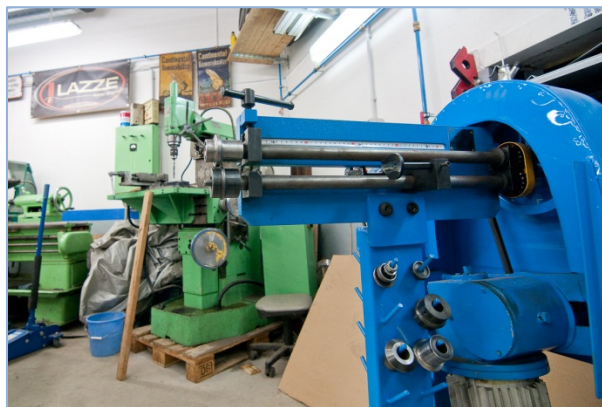
Pilt 124, 125: Sikemasin on vajalik seade keerukamate asendusdetailide valmistamiseks ja seega hea investering
