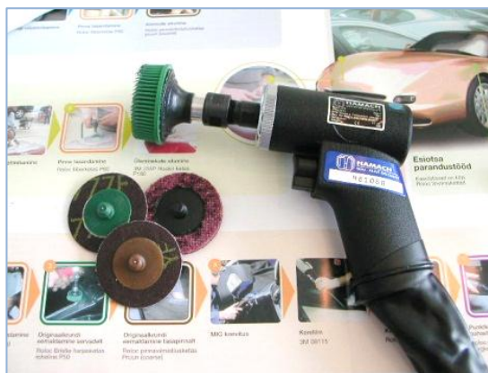
Pilt 10 – Roloc-lihvija on tõhus rooste eemaldaja.
