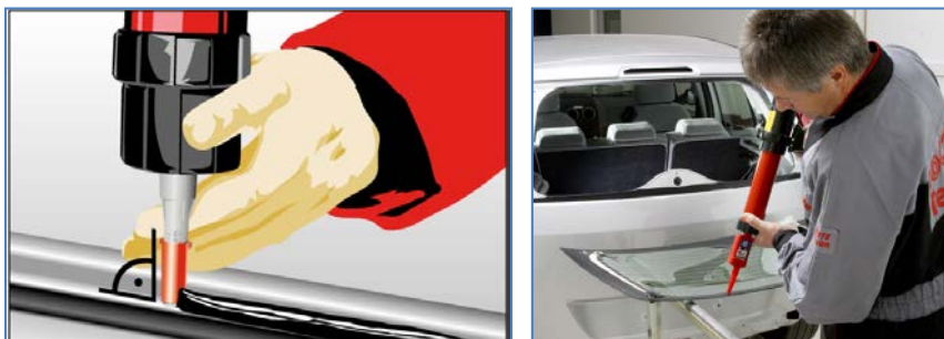
Pilt 31, 32: Klaasile kandes on lihtne hoida püstolit 90° nurga all ja teha katkematu vuuk ühe ühenduskohaga.
