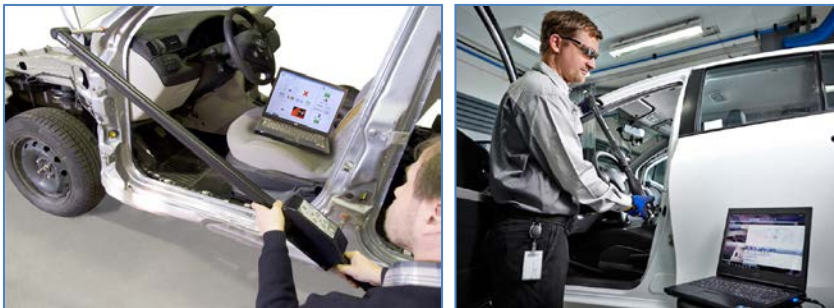
Pilt 146, 147: Autorobot Excaliper ja Car-O-Liner PointX portatiivsed mõõtesüsteemid.
