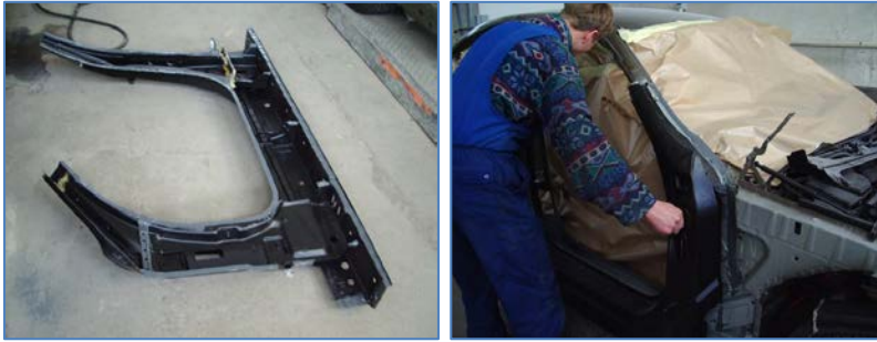
Pilt 55, 56: Liimiga kaetud küljepaneel ja selle paigaldamine.
