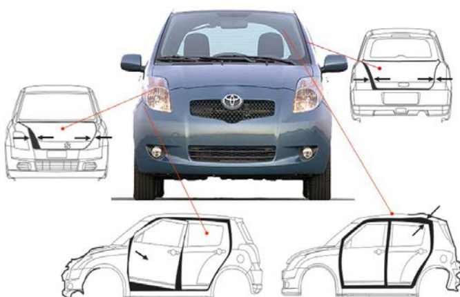
Pilt 8: Uste ja luukide vahede kontroll.
