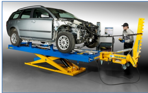
Pilt 75: Eemaldatud rambid võimaldavad lihtsamat ligipääsu autokerele.
