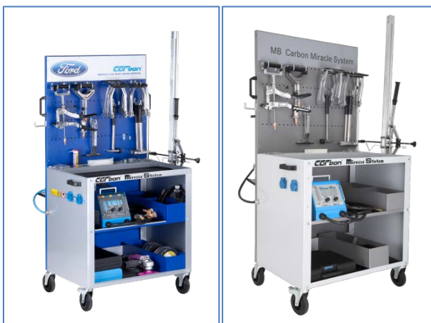
Pilt 49, 50: Carbon Miracle System on autovalmistajate poolt üks enam aktsepteeritud plekiõgvendussüsteeme.
