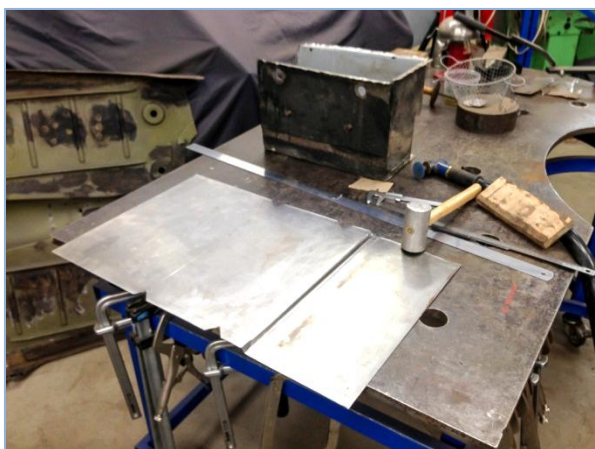
Pilt 97, 98: Selle akukasti koopia valmistamisel kasutati ainult kantmasinat, alumiiniumvasarat/alasi ning punktkeevitust.
