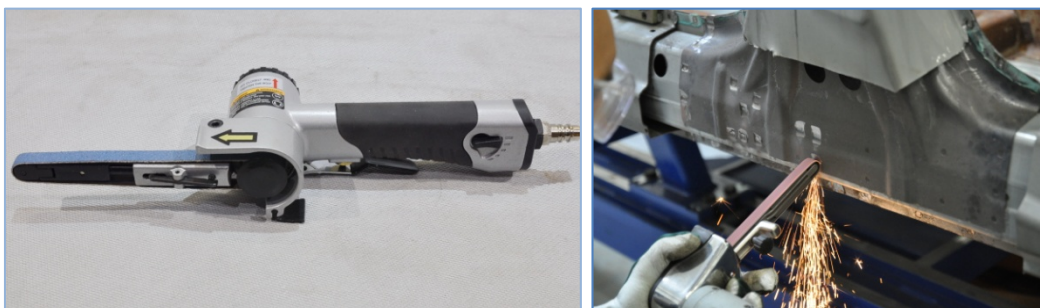
Pilt 32, 33: Lintlihvija ja punktkeevituse punktide väljalihvimine.
