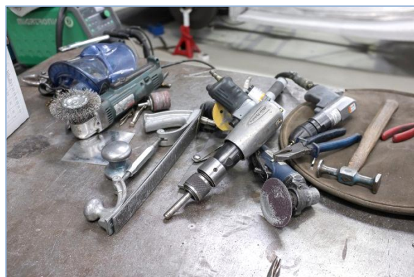
Pilt 142, 143: Lisaks käsitööriistadele on viimistlemisel abi erineva suurusega lihvmasinatelt. Valik plekksepa töölaualt.
