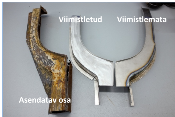
Pilt 141: Peale valmistatud on vaja asendusosa viimistleda.
