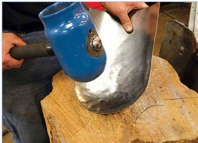
Pilt 100: Pleki venitamine (ja kahandamine) venitusvasaraga puutüvel
