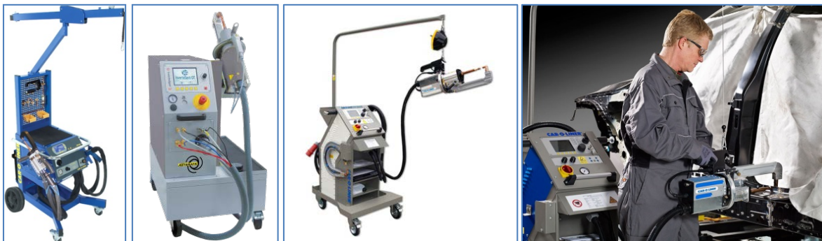
Pilt 52-55: Vasakul poolautomaatne kaabelkeevitus, keskel ja paremal täisautomaatsed käpakeevitused.
