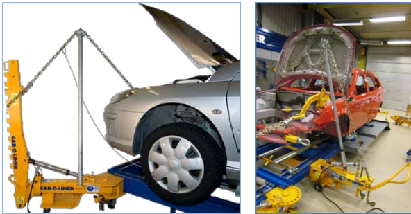
Pilt 120, 121: Ülestõmbe teostamine käänd- ja vektorpoomiga.
