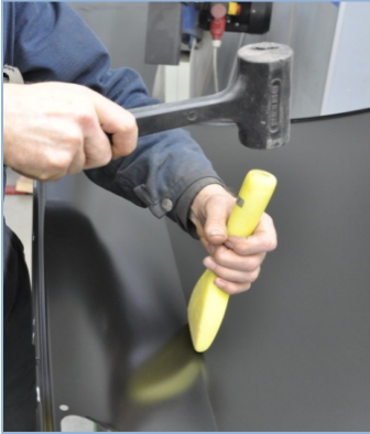
Pilt 26: Kereliini õgvendamiseks on hea kasutada kapronmeislit.
