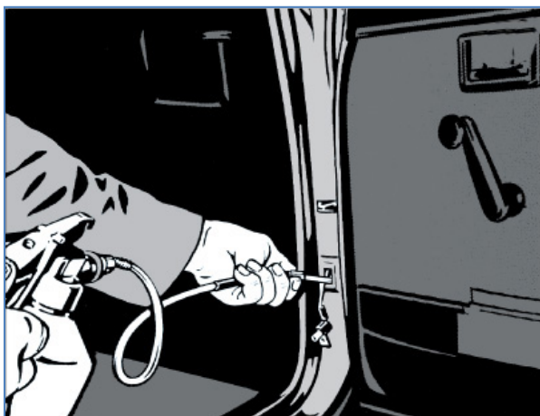
Pilt 52: A-piilari töötlemine pika sondiga.
